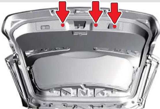
**4** Открутите **пять саморезов** крепления нижней обивки двери багажного отделения. Снимите **нижнюю обивку двери**, отстегнув клипсы. Отсоедините разъем кнопки закрывания багажника.
