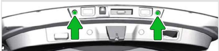
**6** Снимите **разъем камеры**, освободите **крепления** провода к кузову. Отсоедините **3 разъема** и снимите наружную накладку двери багажного отделения.
